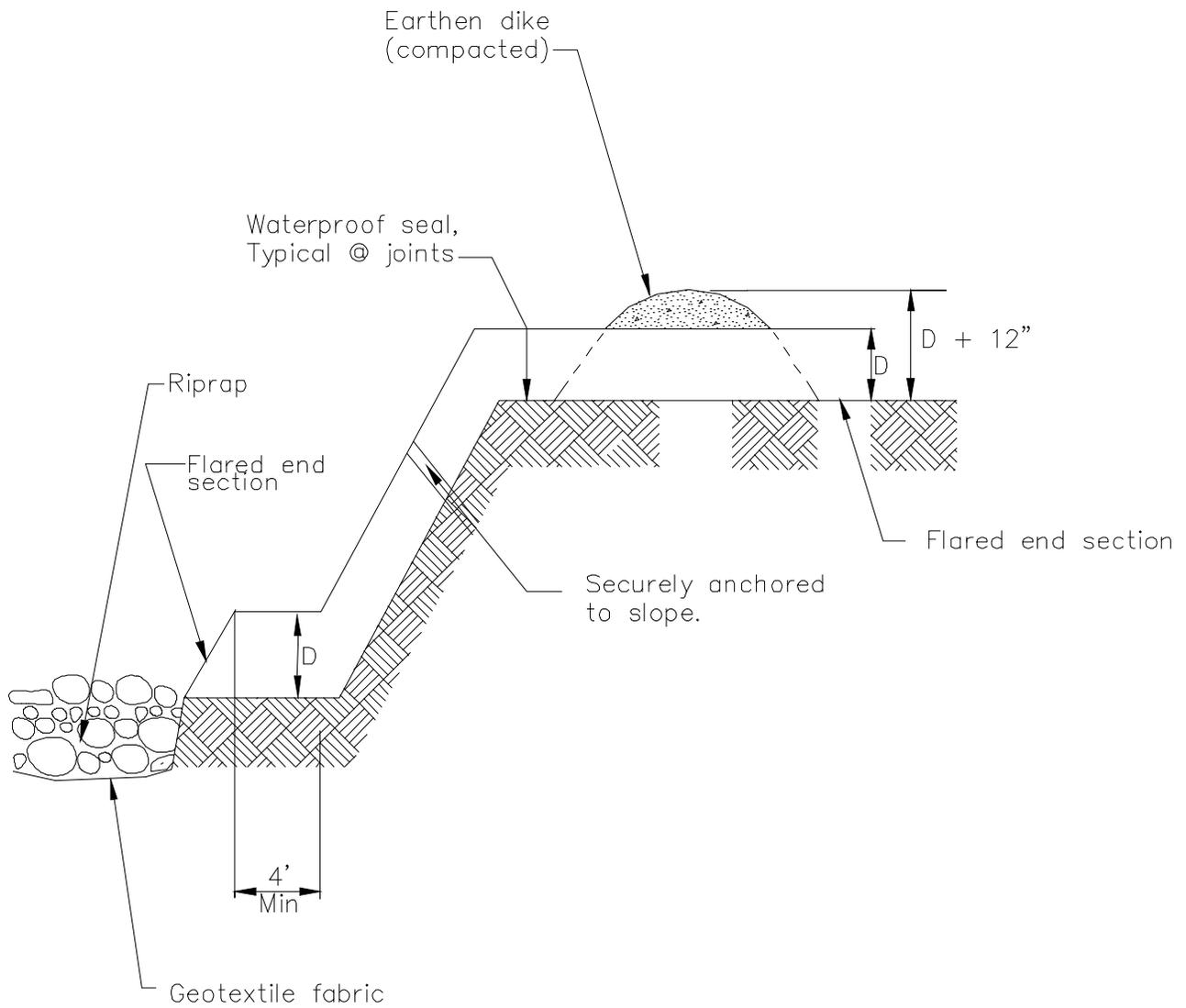
TYPICAL SLOPE DRAIN
